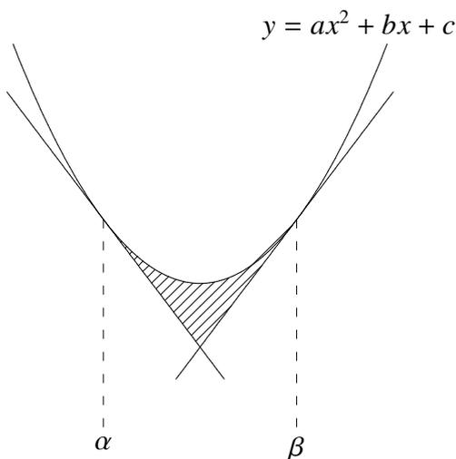
上図のように、放物線と 2 接線によって囲まれる部分の面積  $S$  は、 $S = \frac{a}{12}(\beta - \alpha)^3$  となる。ただし、 $a > 0$  のとき。
